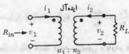
شکل ۶-۲- مقاومت ورودی یک ترانسفورماتور ایده‌آل ختم شده با :
