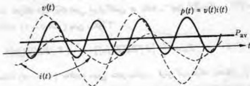
شکل ۷-۲ - شکل موجهای ولتاژ و جریان حالت دائمی سینوسی، و توان لحظه‌ای و متوسط
